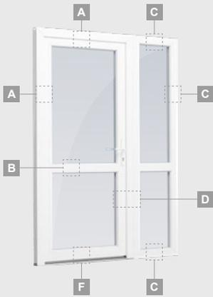
Одностворчатая входная дверь, объединенная с витринным окном. Створка с 2 горизонтальными импостами и стеклянными секциями.
