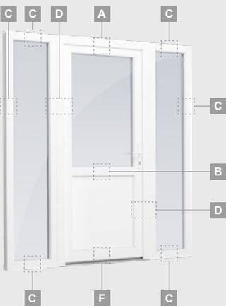
Одностворчатая входная дверь, объединенная с 2 витринными окнами. Створка с 1 горизонтальным импостом, 1 стеклянной секцией и 1 секцией из ПВХ, витринные окна со стеклянными секциями.
