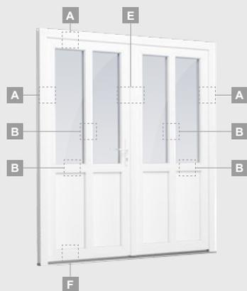
Двухстворчатая входная дверь с 2 горизонтальными импостами Н1050 и 4 вертикальными импостами, с 4 стеклянными секциями и 4 секциями из ПВХ
