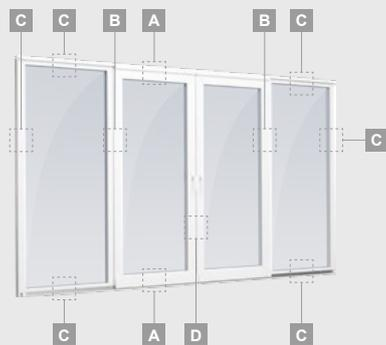
4-секционная откидная-раздвижная дверь. Две подвижные створки – посередине.
